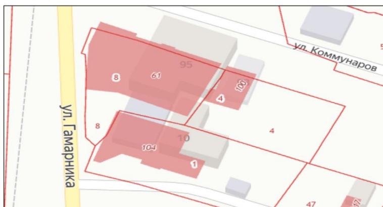
Рис. 5. Пример пересечения границ объектов капитального строительства
