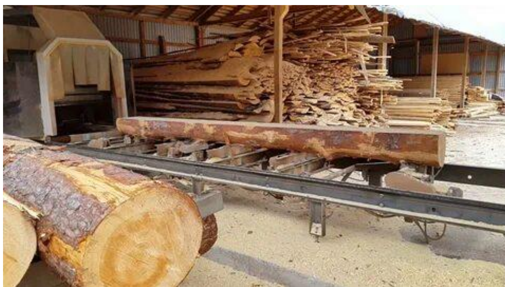
Рис. 4. Установка по распилу бревен
