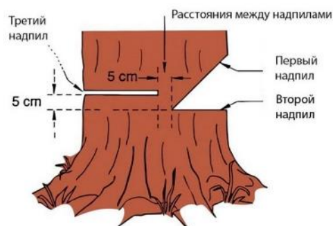
Рис. 4. Этапы правильной валки леса бензопилой
