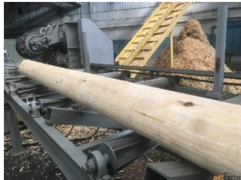
Рис. 7. Технология «окорка» на современном деревообрабатывающем оборудовании
