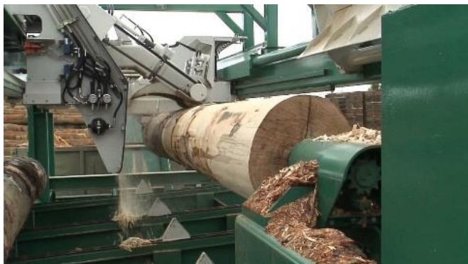
Рис. 7. Технология «окорка» на современном деревообрабатывающем оборудовании
