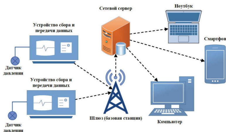
Рис. 1. Схема взаимодействия устройств в сети для мониторинга давления в трубопроводах
