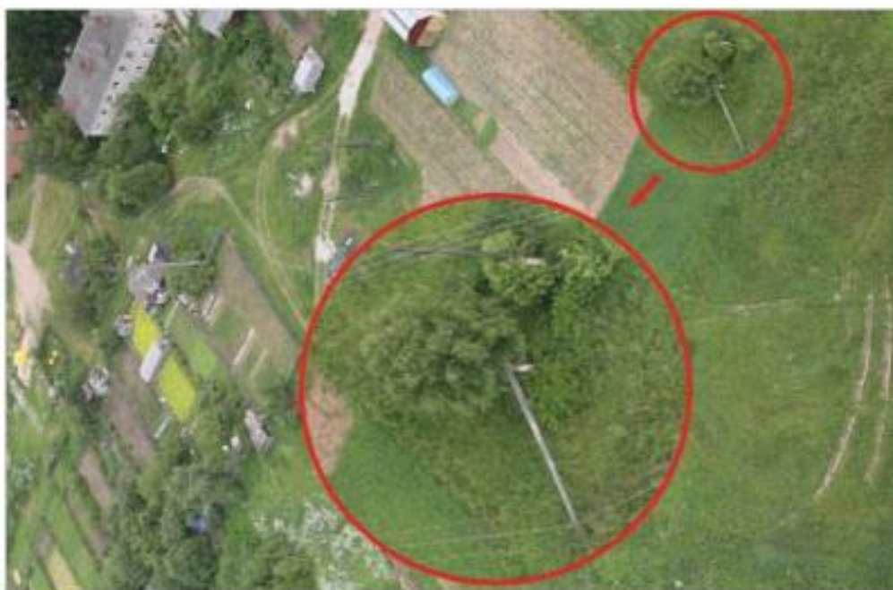
Рис. 10. Упавшая опора на снимке с разрешением пикселя на местности 0,7 см, полученном с помощью БАС
