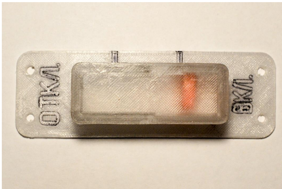
Рис. 2. Индикаторное окошко из прозрачного ПЭТ
