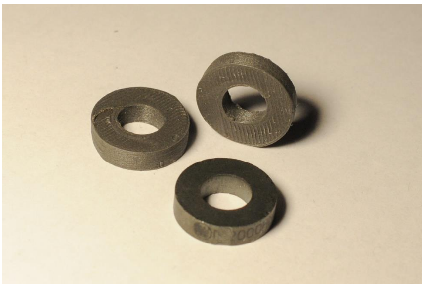
Рис. 3. Тороидальные сердечники (напечатанные – 2 сверху, из феррита – снизу)
