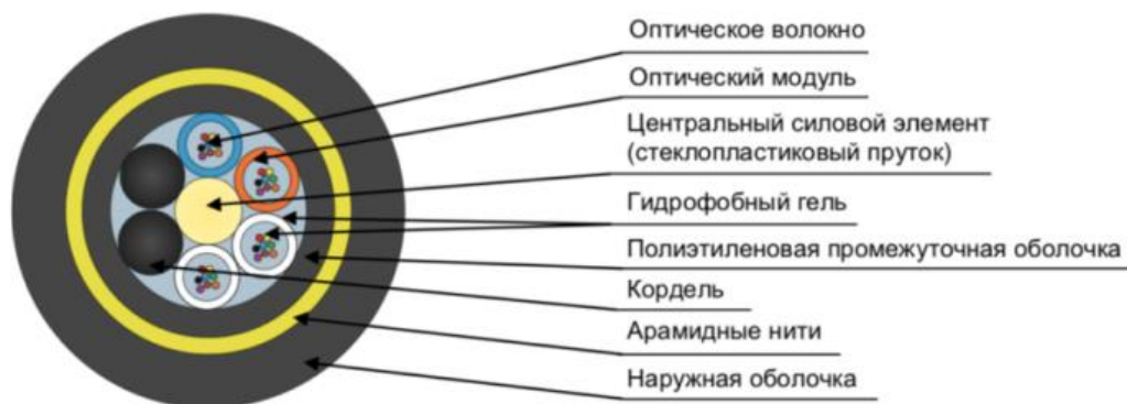
Рис. 4. Поперечное сечение ОКСН
