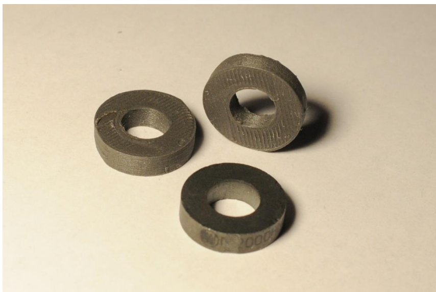
Рис. 3. Тороидальные сердечники (напечатанные – 2 сверху, из феррита – снизу)
