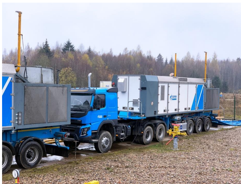
Рис. 2. Мобильная компрессорная станция
