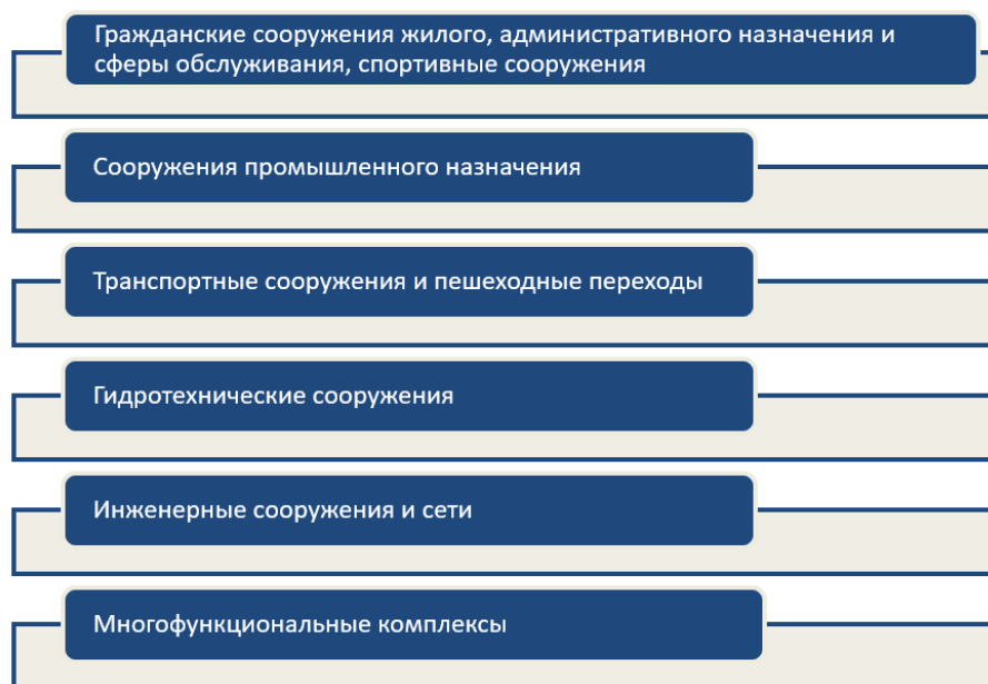
Рис. 1. Номенклатура подземных объектов в соответствии с их назначением
