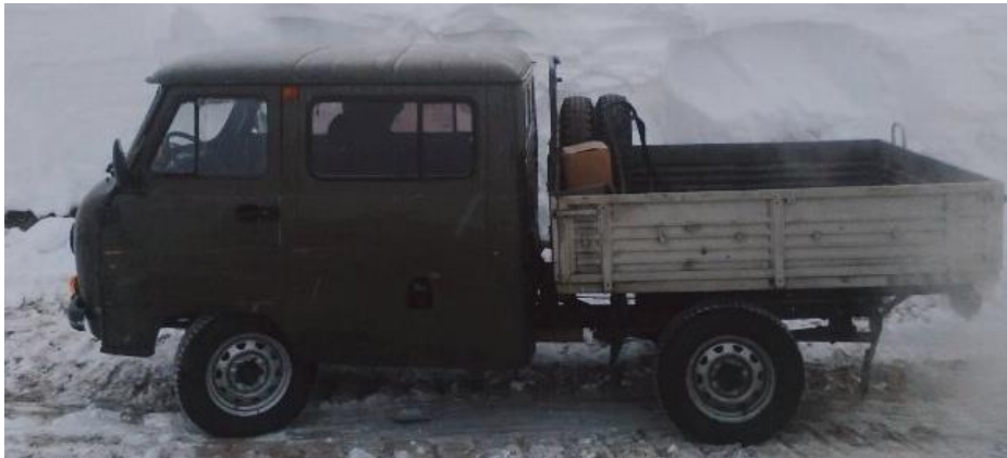
Рис. 1. Передвижная маслозаправочная станция на базе УАЗ-39094
