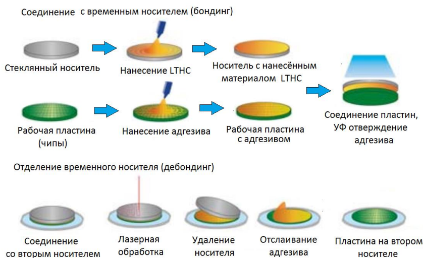
Рис. 1. Изображение последовательности операций технологии бондинга/дебондинга от 3М (3М WSS) (на примере соединения двух пластин – рабочей и носителя) [3]
