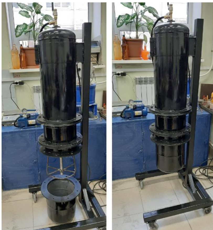
Рис. 1. Вакуумный бетоносмеситель: слева – смеситель со снятой емкостью для перемешивания; справа – готовый к работе смеситель
