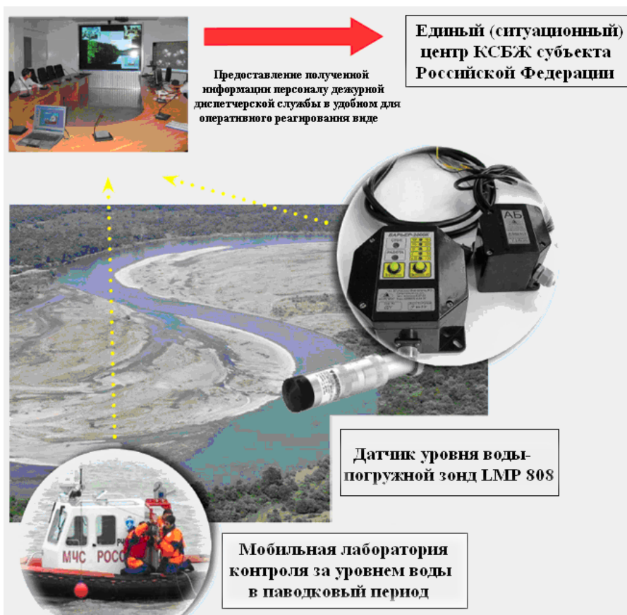
Рис. 1. Структурная схема подсистемы мониторинга паводковой обстановки
