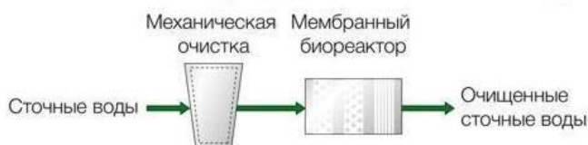
Рис. 1. Классическая схема процесса очистки сточных вод
