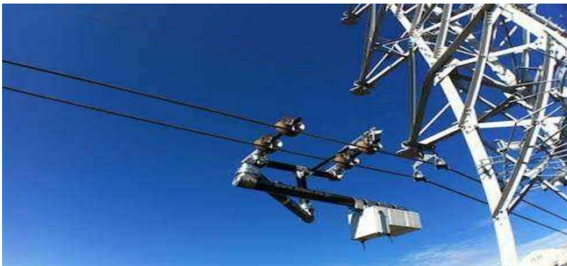
Рис. 1. Робот Expliner для диагностики ЛЭП
