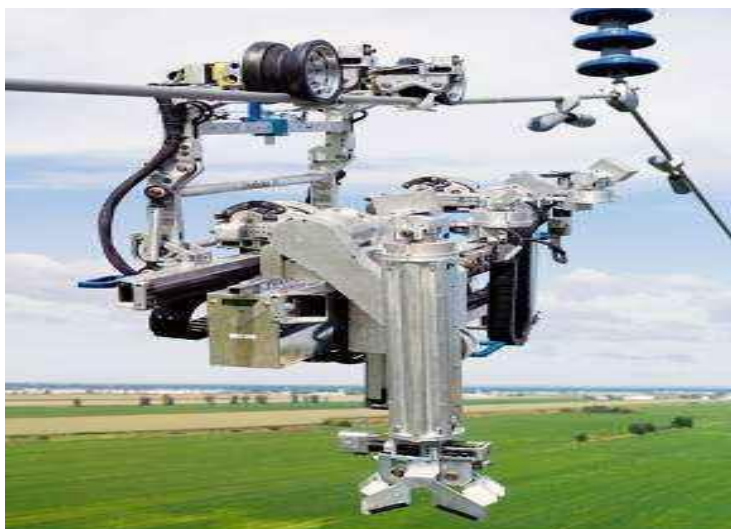
Рис. 2. Робот LineScout, для диагностики и ремонта ЛЭП
