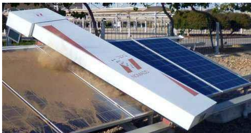
Рис. 3. Робот для очистки солнечных панелей
