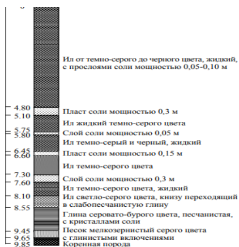
Рис. 1. Профиль донных отложений центральной части оз. Масазыр (составлен по материалам Я.В. Гаврилова)
