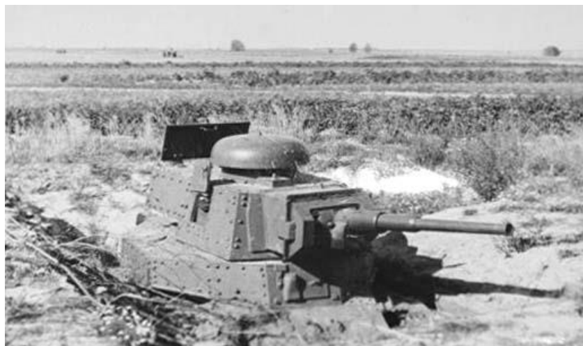
Рис. 1. БОТ из МС-1, переоборудованного под установку 45-мм пушки. Осень 1941 года
