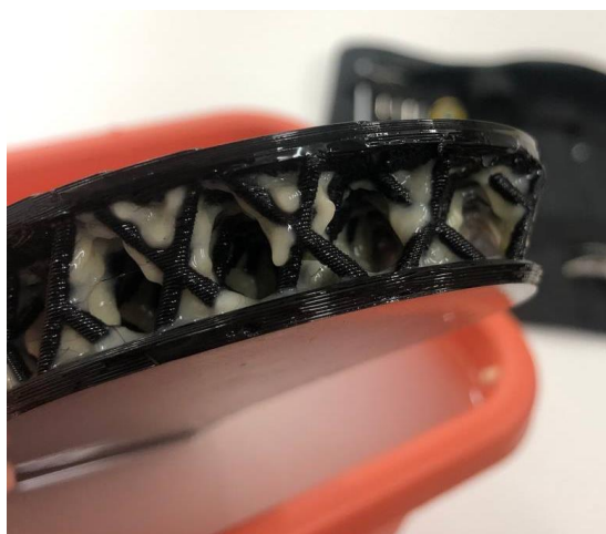
Рис. 3. Процесс удаления поддержек
