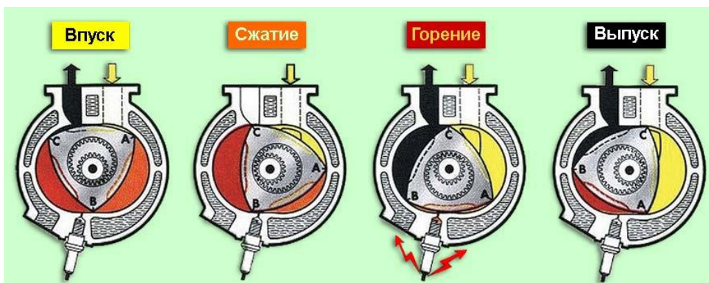
Рис. 1. Стадии работы роторного двигателя [1]
