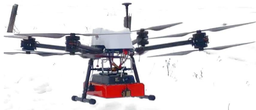
Рис. 2. Ледомер ЛД-400. Измеряемая толщина льда и снега в режиме зависания на высоте 5-10 м. – не менее 2 м. Частота антенны 400 МГц [3]
