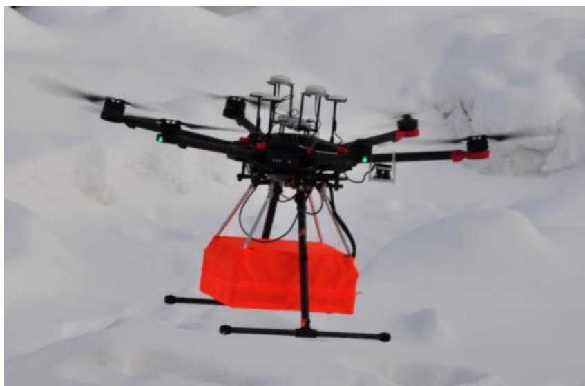
Рис. 1. Георадар Zond-12e Drone 500A установлен на коптер DJI M600 Pro. Частота антенны 500 МГц [1]
