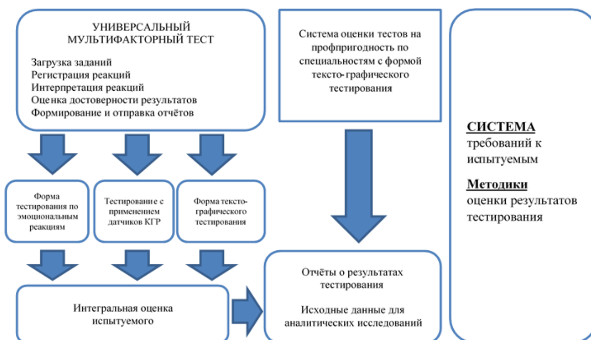
Рис. 1. Функциональная схема мобильной лаборатории тестирования
