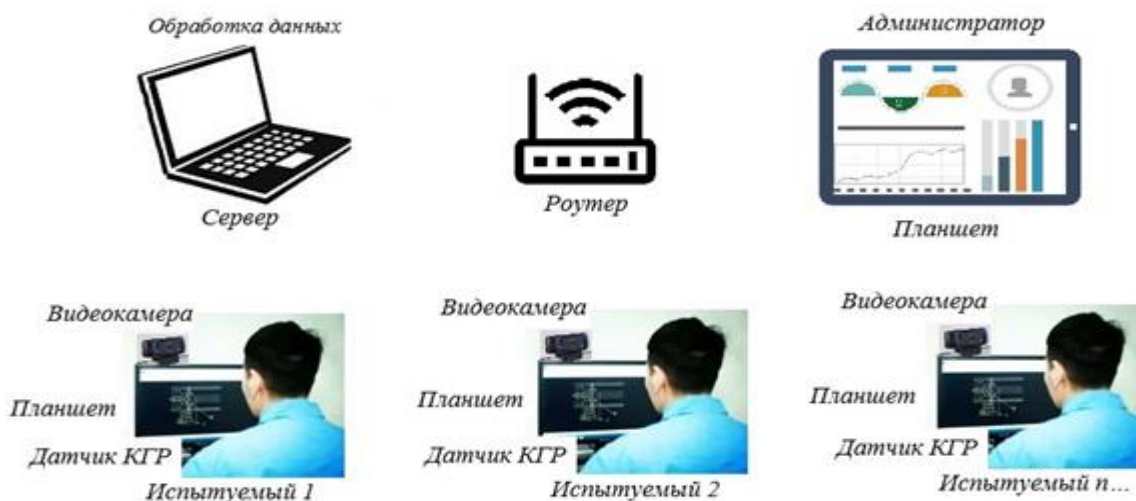
Рис. 3. Структурная схема технической части лаборатории тестирования
