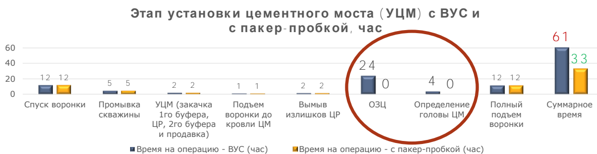
Рис. 6. Этап установки цементного моста с ВУС и с «Пакер-пробкой», час
