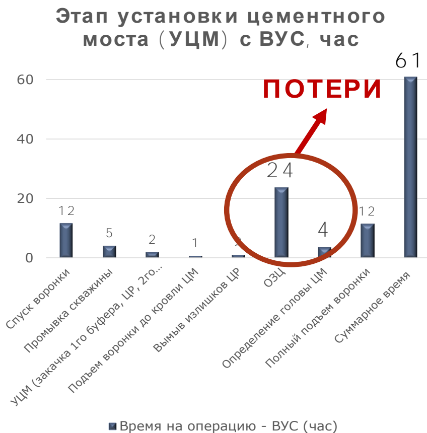
Рис. 3. Этап установки цементного моста с ВУС
