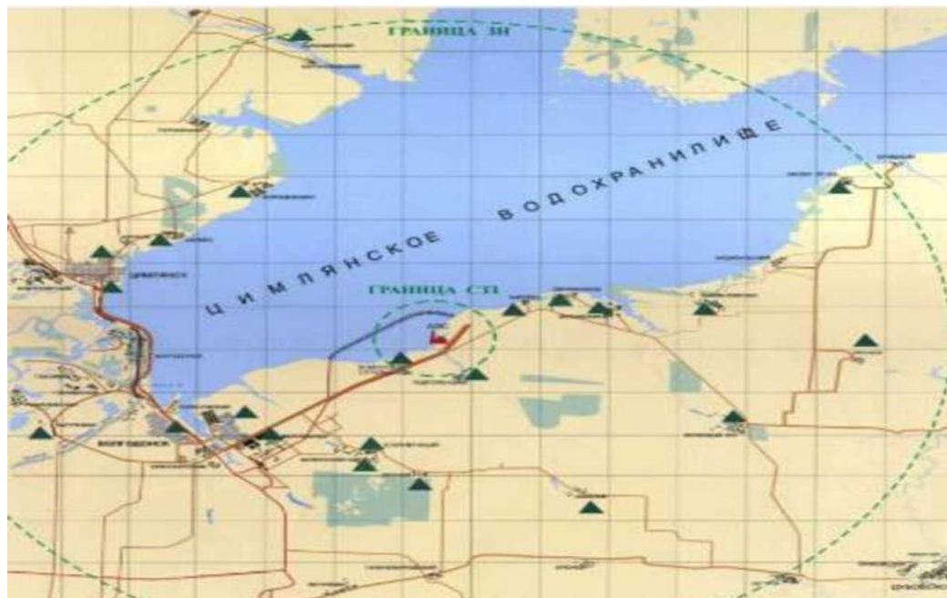
Рис. Схема расположения постов автоматизированного радиационного контроля (АСКРО) в районе Ростовской АЭС [4]
