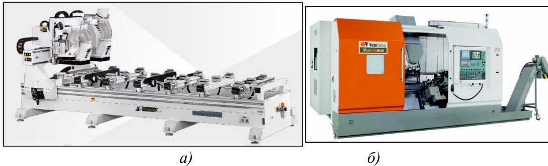
Рис. 4. Фрезерные станки с ЧПУ: а) обрабатывающий фрезерный центр с ЧПУ; б) токарно-фрезерные обрабатывающие центры с ЧПУ
