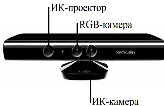
Рис. 1. Компоненты сенсора Kinect [2]
