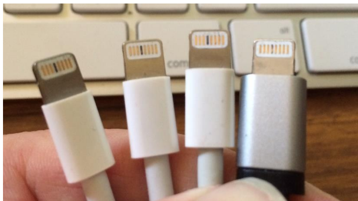
Рис. 5. Пример почерневших пятых контактов на коннекторах
