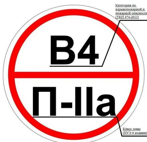
Рис. 2. Знак категории помещения пожарной опасности
