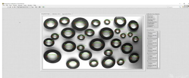
Рис. 1. Программа Labview, которая определяет диаметр шайб
