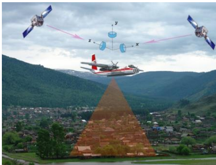
Рис. 1. Принцип воздушного лазерного сканирования
