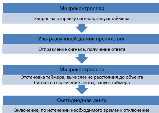
Рис. 2. Принцип работы нерегулируемого пешеходного перехода
