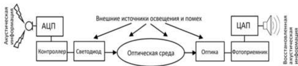
Рис. 1. Схематическое описание акустического канала утечки информации по видимому свету [3]
