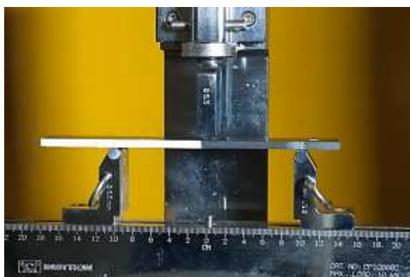
Рис. 4. Образец ПКМ №4 с начальным расслоением в испытательной оснастке для испытаний на трещиностойкость по типу II
