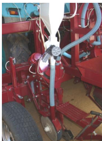
Рис. 1. Общий вид дозирующего устройства для внесения полимерного гидрогеля в почву
