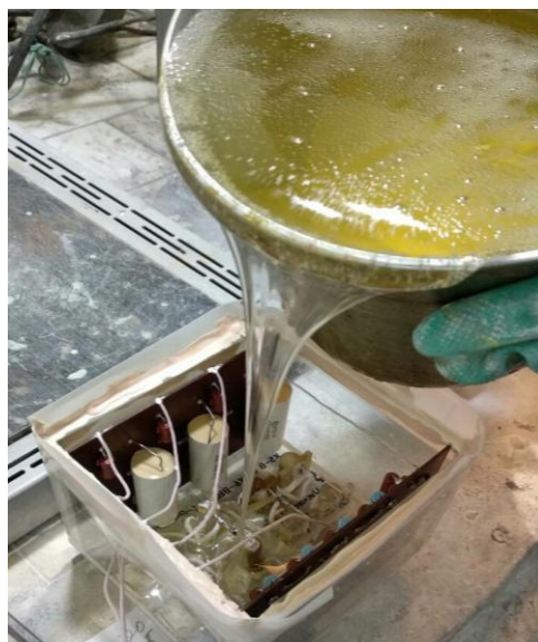
Рис. 3. Заливка высоковольтного источника питания
